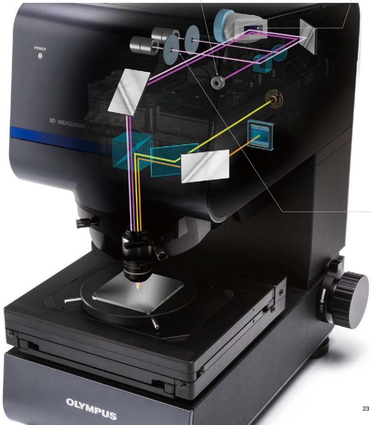
Красный лазер 658 нм, пара линий – 0,26 мкм.
