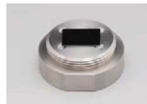
Калибровочный образец Z OLS50-CS-Z
