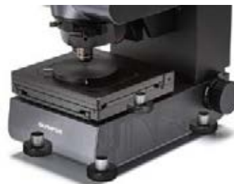
Гибридный механизм гашения вибраций
