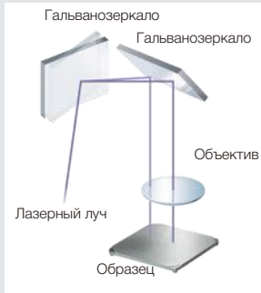
Традиционный лазерный микроскоп (приближенная гальвано-структура)
